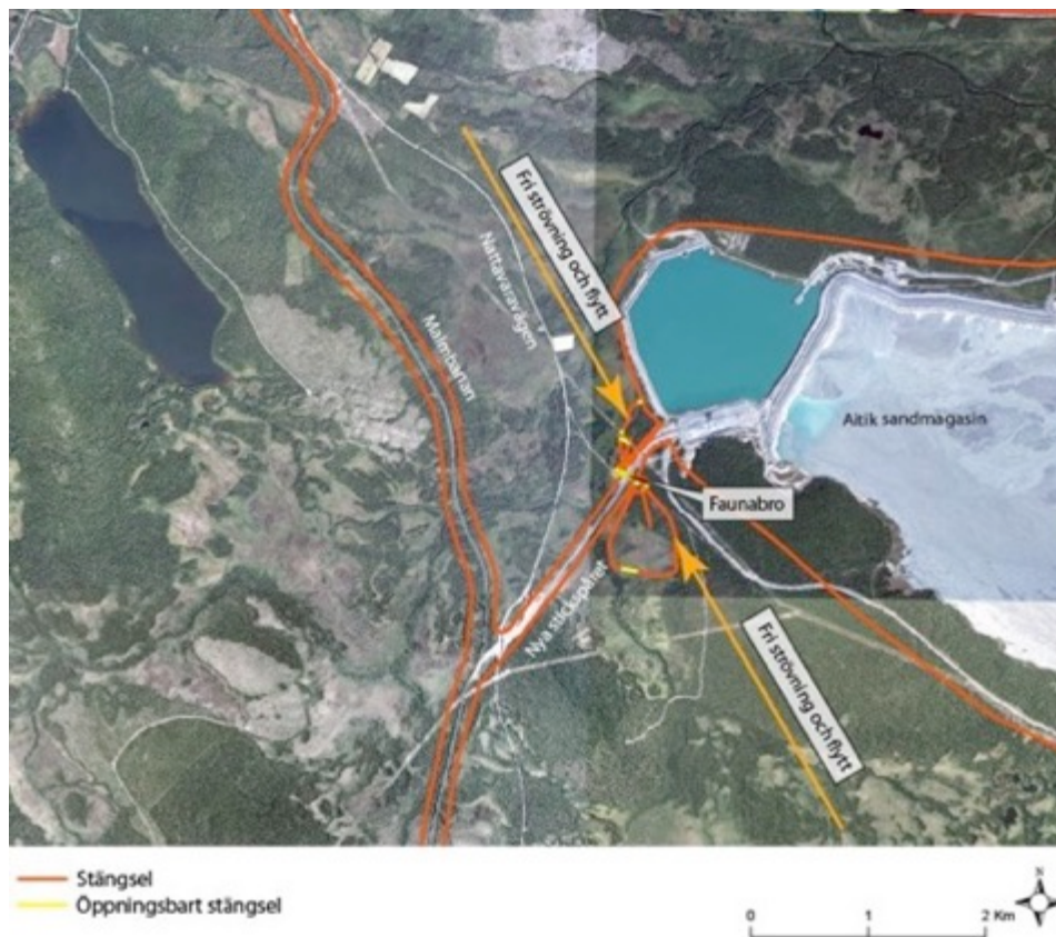
Figur 16. Faunabron med dess samlingshagar vid Aitik byggdes för att underlätta flytt och fri strövning för renar över det nya stickspåret mellan Aitikgruvan och Malmbygröden. Den gamla flyttleden gick utmed myrsystemen cirka 50 meter längre västerut.
